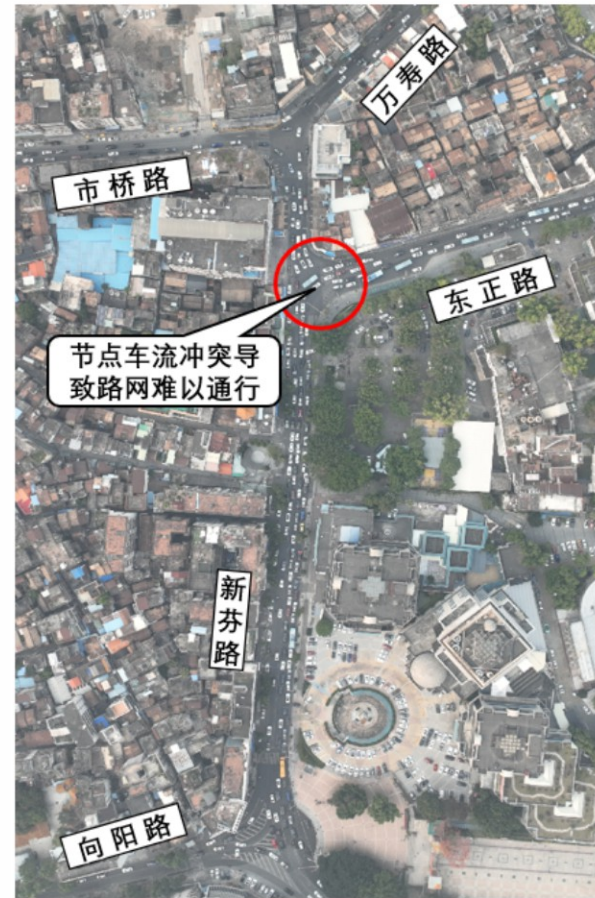
图8. 莞城中心小学附近异形交叉口车流冲突示意图
